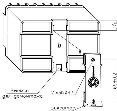
Рисунок Б.2 Вариант крепления на панель
