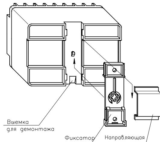
Рисунок Б.1 Вариант крепления на направляющую
