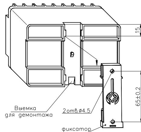
Рисунок Б.2 Вариант крепления на панель
